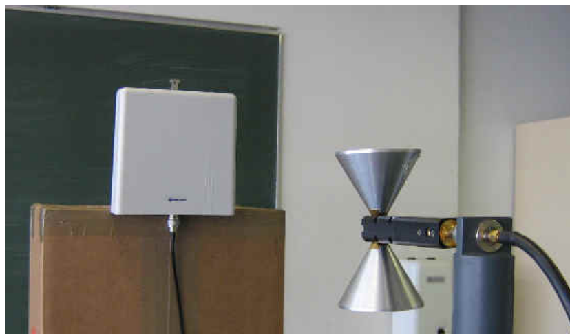
Figure N°14 : Antenne d'émission RFID et antenne biconique de me sure. Photo Supélec
