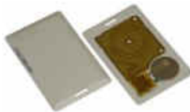
Figure N°4 : Exemple d'étiquettes RFID actives. D'après « RFID : résistance et compatibilité des matériaux »
